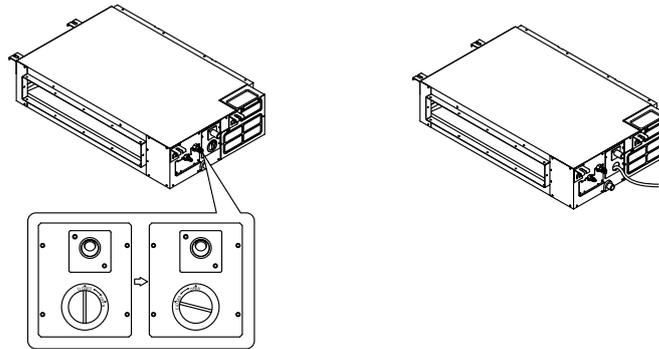
2. Включите кондиционер и установите его в режим охлаждения. Прислушайтесь к звуку работы дренажного насоса. Проверьте, как сливается вода из дренажного шланга (в зависимости от длины шланга задержка слива конденсата в дренаж может составить до 1 минуты). Кроме того, проверьте герметичность соединений.
