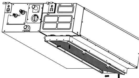
4. Закрепите фильтр в предусмотренных крепежных отверстиях на фланце.
